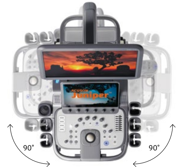
Drehbarkeit um 90° nach rechts und nach links für eine flexible Positionierung der Schallkopf-Konnektoren
